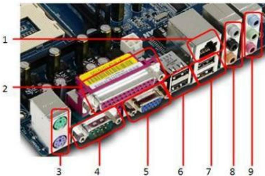
Укажите разъем для подключения монитора.
