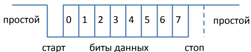
Рисунок 24. Формат передачи данных через последовательный порт.
