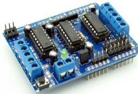
Рисунок 13. Внешний вид платы расширения MotorShield L293D
