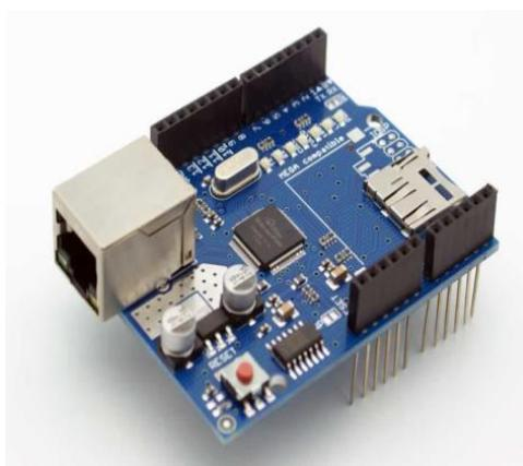
Рисунок 21. Плата расширение Ethernet Shield.
