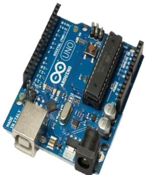
The Arduino Uno is a blue printed circuit board featuring a central ATmega328 microcontroller. It has a USB port, a power jack, and various pins and components around the perimeter.                                  | <b>Arduino UNO</b><br>Микроконтроллер на базе процессора ATmega328. 14 цифровых входов/выходов, 6 из которых могут быть использованы как ШИМ выходы, 6 аналоговых входов, тактовая частота 16 МГц, подключение пошине USB, питание как от USB, так и внешнее.        |
