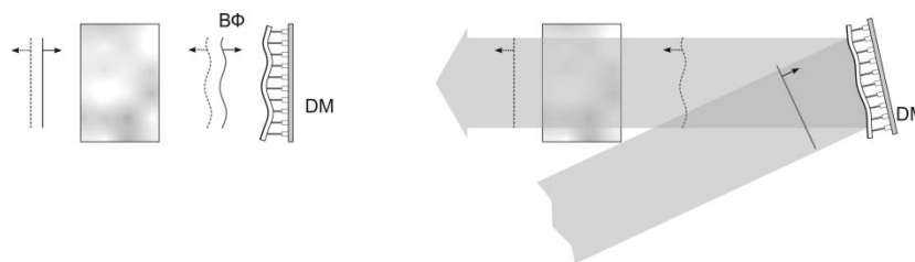
Рисунок 9.3 – Исправление искажений волнового фронта с помощью деформируемого зеркала (DM) – двухпроходный и однопроходный варианты.
