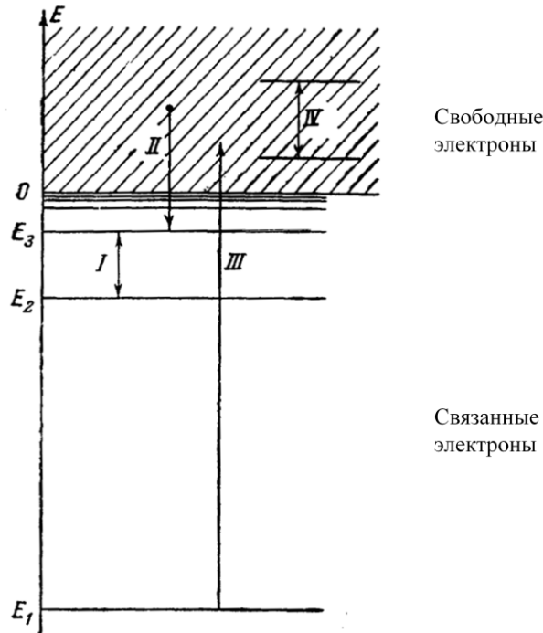
Рисунок 39 – Схема энергетических уровней системы протон-электрон [16]
