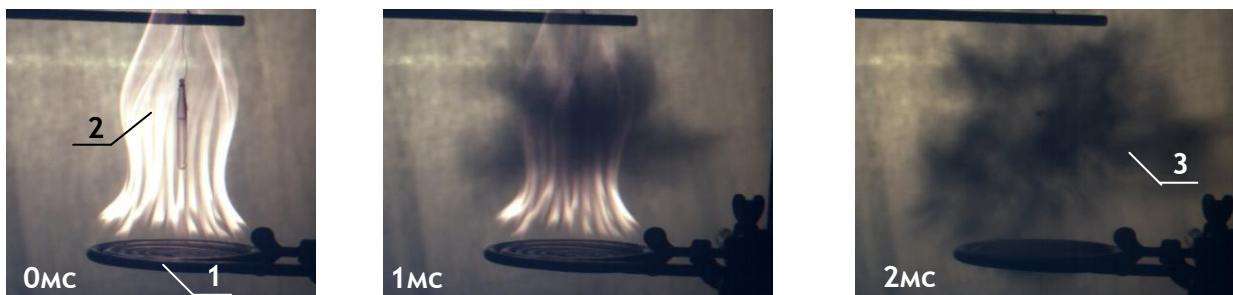
Рис. 8. Кадры видеोगраммы опытов по тушению пламени спиральной газовой горелки (диаметром \sim 10 см) облаком ДВ при паровом взрыве цилиндрической стеклянной капсулы ( L=45 мм, d=5 мм, \Delta=0.5 мм, V_{\text{воды}}=0.25 мл), помещенной в пламя горелки. 1 – спиральная горелка; 2- пламя горелки; 3 – облако ДВ, образовавшееся при взрыве капсулы.
