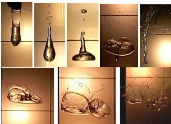
Фиг.6. Трансформация цилиндрического водяного снаряда ( $V=45$  мл,  $h/d=2.4$ ) (верхний ряд) и конечная стадия разрушения снаряда под действием неустойчивости Рэлея-Тейлора ( $V=45$  мл,  $h/d=1.23$ ) (нижний ряд) [9].
