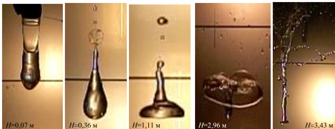
Свободное падение и трансформация цилиндрического водяного снаряда (45 мл, h/d=2,4 , «длинный» снаряд). H -путь, пройденный снарядом на данный момент времени.
