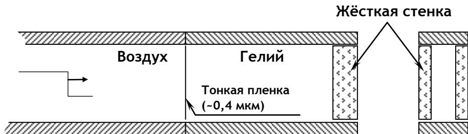
Рисунок 4 Схема измерительной секции ударной трубы в экспериментах по исследованию развития зоны турбулентного перемешивания на плоской границе воздух-гелий, ускоряемой ударными волнами
