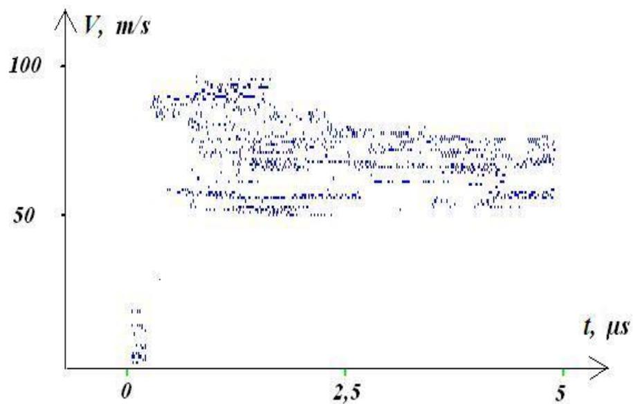
Рисунок 2. - Результаты измерений зависимости от времени  $t$  скорости облака капель воды  $V$ , полученных методом PDV в опыте с водой (для инъекций). В экспериментах с такой водой максимальная скорость оказывается на уровне  $\sim 90$  м/с.
