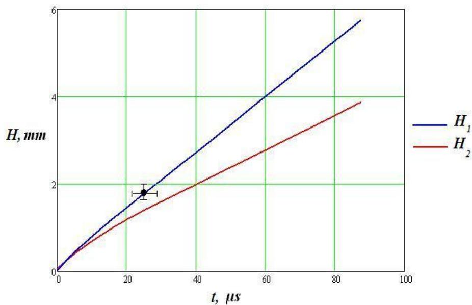
Рисунок 3. Зависимость от времени пути, пройденного границей летящего облака диспергированной воды для инъекций  $H_1(t)$ , полученная путем интегрирования зависимости  $V(t)$  (рис. 2) (верхней границы облака точек). Нижняя кривая  $H_2(t)$  получена путем интегрирования зависимости огибающей нижней границы облака точек  $V(t)$ . Здесь также приведен результат опыта, полученной фотографической регистрацией (рис. 1).
