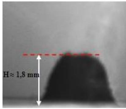
Рисунок 1. Фотография процесса разлета в воздух слоя воды (для инъекций) на момент времени  $t = 25$  мкс.
