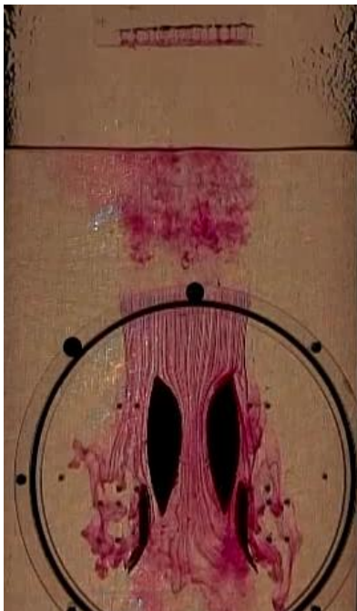
Рис.4. Визуализация течения около плоской модели ускорителя потока при помощи набора струек, окрашенных марганцовокислым калием.
