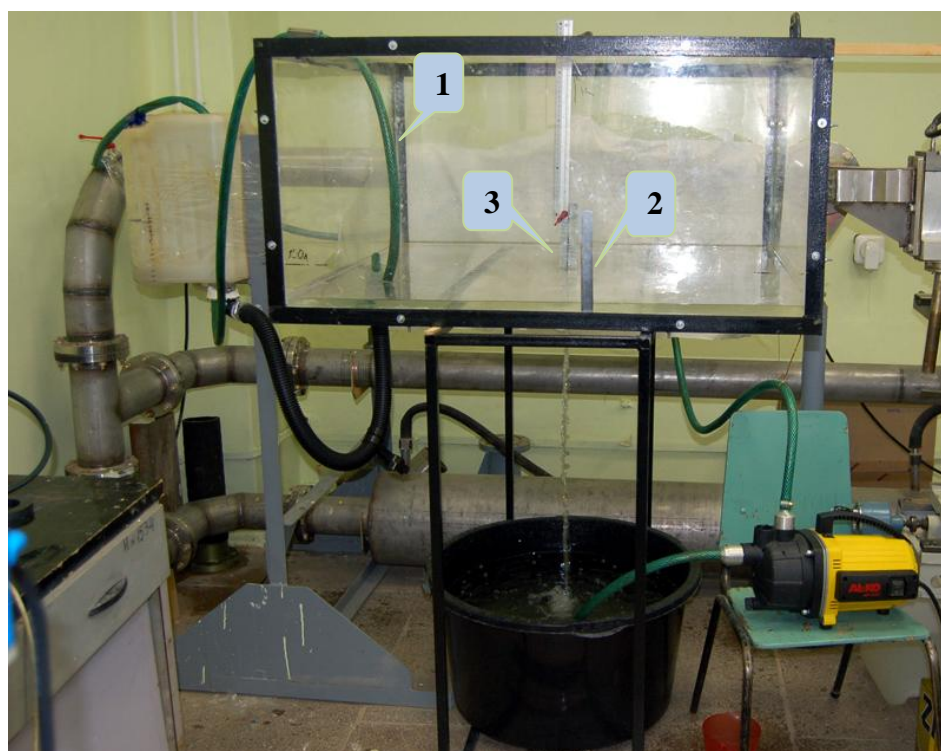
Рис.1 Лабораторная установка. 1-трубка для подачи воды в аквариум, 2-линейка для измерения уровня воды в аквариуме, 3- разделитель, установленный над сливным отверстием
