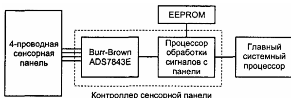
Рис. 2.166. Структура интерфейса «сенсорная панель» на основе chipset MT410
