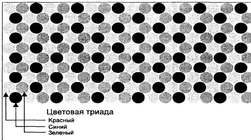
Рис. 1.3. Расположение зерен люминофора на экране ЭЛТ цветного монитора
