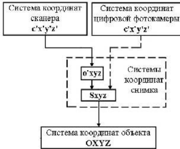
Рисунок 3.3 - Схема преобразований координат при обработке одиночного снимка
