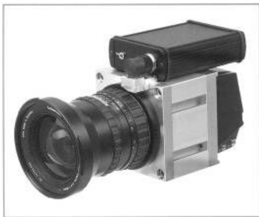
Рисунок 4.2 - Среднеформатная цифровая аэрокамера Rollei AIC (размер матрицы камеры 49x37 мм (5440x4080 пикс, размер полного кадра 39 Мегапиксел, размер пикселя 6.8 мкм)
