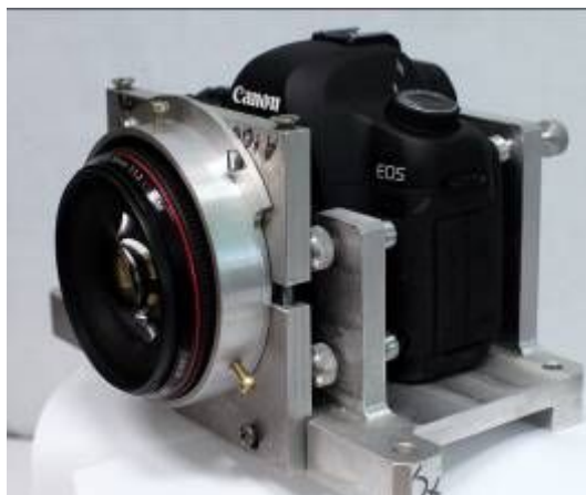
Рисунок 4.6 – Варианты фиксации объектива камеры для сохранения фокусировки: а, б) РЯЦ-ВНИИЭФ (г.Саров); в) V-Stars (США)
