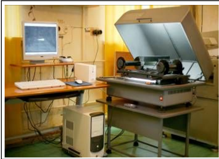
Рисунок 2.3 - Фотограмметрический сканер «Дельта» (Украина)
