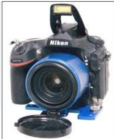
Рисунок 4.6 – Варианты фиксации объектива камеры для сохранения фокусировки: а, б) РЯЦ-ВНИИЭФ (г.Саров); в) V-Stars (США)
