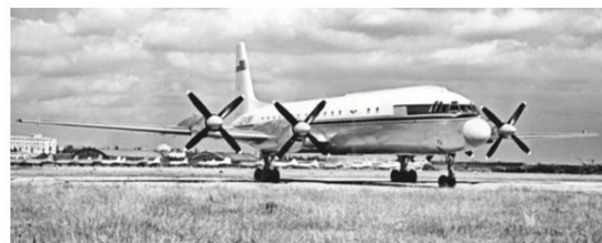
Пассажирский самолет Ил-18 с турбовинтовыми двигателями
