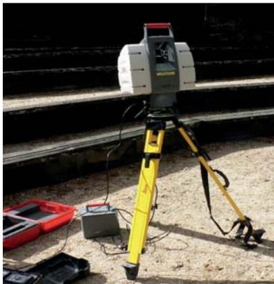
Рис.1. Лазерный сканер координат объекта
