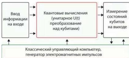
Рис. 1 Схема квантового компьютера
