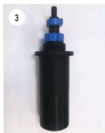
1 – источник магнитного поля (катушки Гельмгольца), 2 – резонатор с системой запитки пьезоэлементов, 3 – корпус системы позиционирования резонатора
