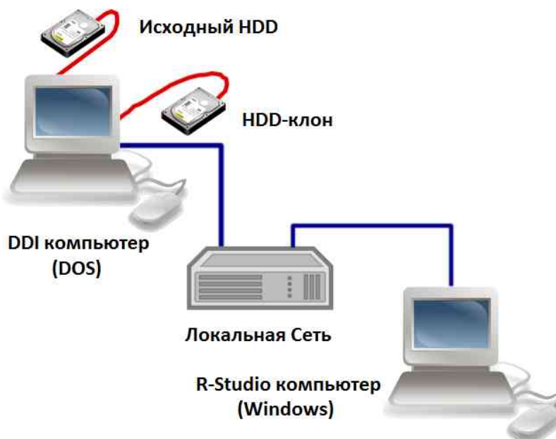
Рис.1 Схема работы аппаратного средства DeepSpar Disk Imager и программного обеспечения R - Studio
