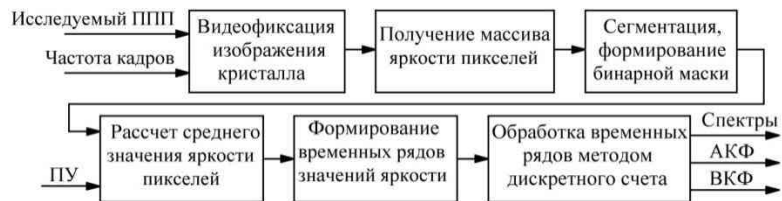
Рис. 1. Алгоритм оценки параметров флуктуаций свечения кристаллов ППП при МП пробое
