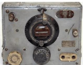
**РСИ-4** — средство связи между наземными и воздушными войсками. (Образец 1942 г.)
