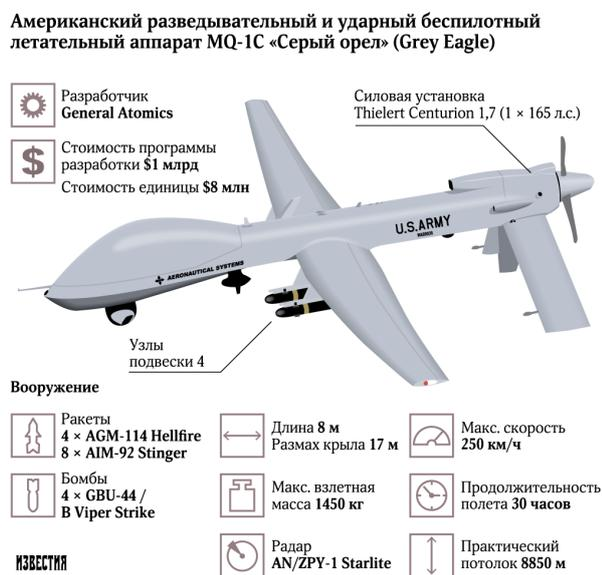
Рис. 1. БПЛА MQ-1C "Gray Eagle"
