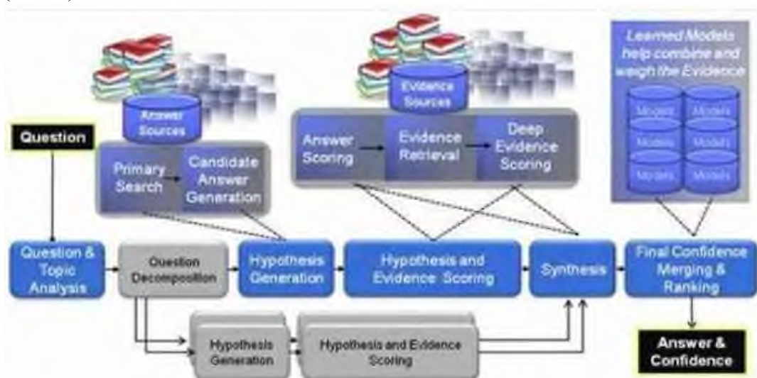
Рисунок 1. Алгоритм работы системы IBM Watson
