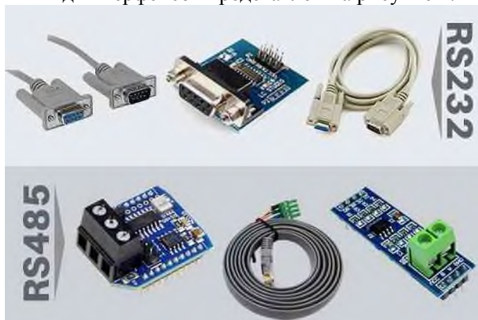
Рисунок 1. Внешний вид интерфейсов RS-232 и RS-485
