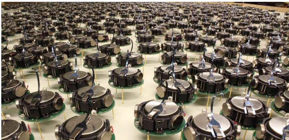
Рисунок 1. Рой роботов с датчиками колебаний
