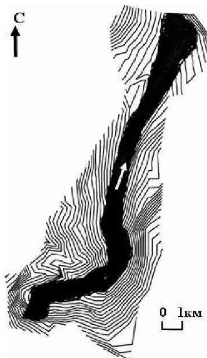
Рисунок 1. Результаты моделирования схода ледника с применением модели DEBRIS
