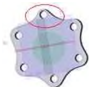
Рис. 1. «Фланец» построенный массивом
