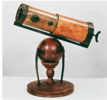
Первый зеркальный телескоп Ньютона
