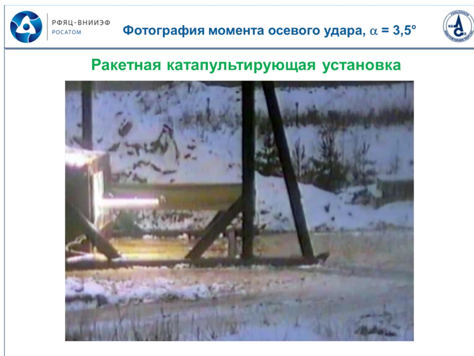
Рисунок 8.6. Фотография момента осевого столкновения ТК-С7М с преградой
